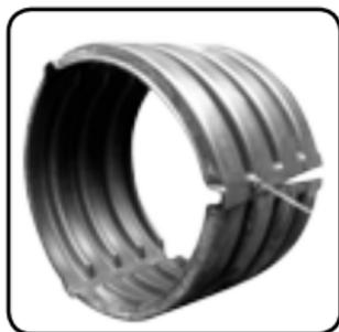
Existem projetos onde só se deseja um sistema de conexão com hermeticidade de aglomerados grossos. Para conseguir este tipo de conexões, pode utilizar-se, em tubos de até 1200mm de diâmetro, conexões bipartidas ou split couplers, chamadas também juntas tipo abraçadeira.
