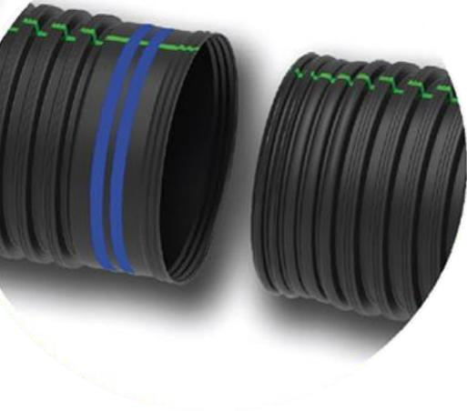
Esta especificación describe la tubería DrenPro Infra® de polietileno de Alta Densidad (PEAD) de doble pared, con exterior corrugado anular e interior liso, con diámetros interiores que van desde 100 mm a 1.500 mm, para ser utilizada en drenaje y aireación de pilas, conducción de flujo gravitacional, conducción eléctrica, canalización, tránsito vehicular y puedan o no solicitar hermeticidad.
