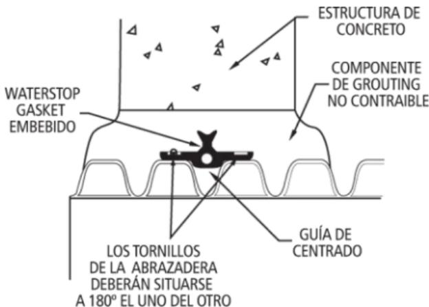
Nunca deje la campana inserta en la pared de la estructura de concreto. Esta debe ser previamente eliminada. Está permitido que la espiga del tubo quede embebida en el hormigón.
