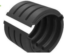
Fitting inyectado de HDPE, es utilizado para realizar uniones que requieren resistencia a la separación y que no necesita de hermeticidad. Sistema tipo abrazadera, utiliza amarras de HDPE, su diseño es óptimo para la tubería DrenPro One®.
