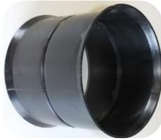
Fitting inyectado de HDPE, recomendado para uniones entre tuberías que requieren hermeticidad, su inserción mecánica no necesita maquinaria extra debido a que cuenta con dos gomas elastómeras que sellan la unión. Norma internacional **ASTM D3350**.
