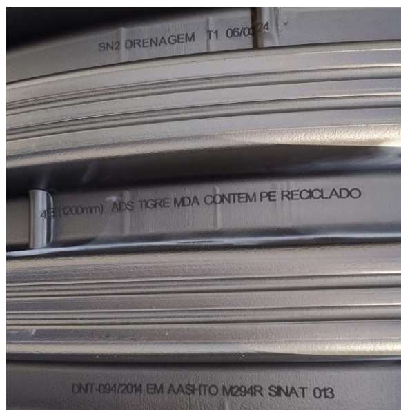
Figura 8 – Marcação impressa nos tubos produzidos na unidade fabril de Marechal Deodoro/AL.
