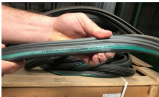
Figura 11 – Anel de vedação utilizado nas uniões entre os tubos.
