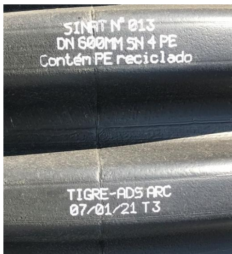
Figura 7 – Marcação impressa nos tubos produzidos na unidade fabril de Rio Claro/SP.
