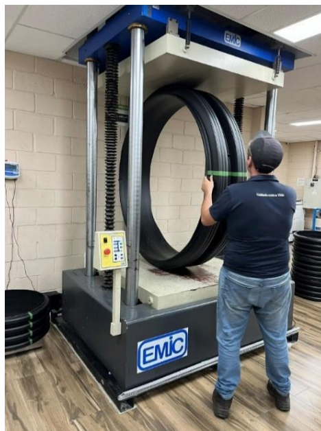
Figura 19 – Ensaio de rigidez anelar – tubo corrugado DN1500.
