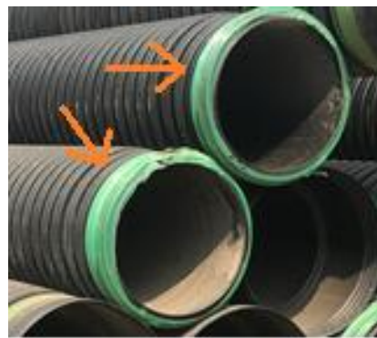
(b) Proteção dos anéis elastoméricos.
